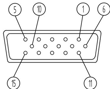
**Achtung:** Nicht belegte Pins unbedingt frei lassen! Diese werden werkseitig verwendet!
